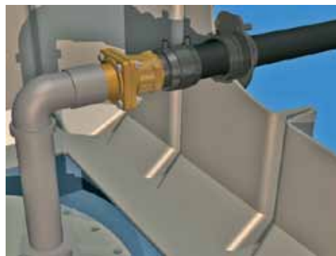
Figura 12: Montagem do tubo
